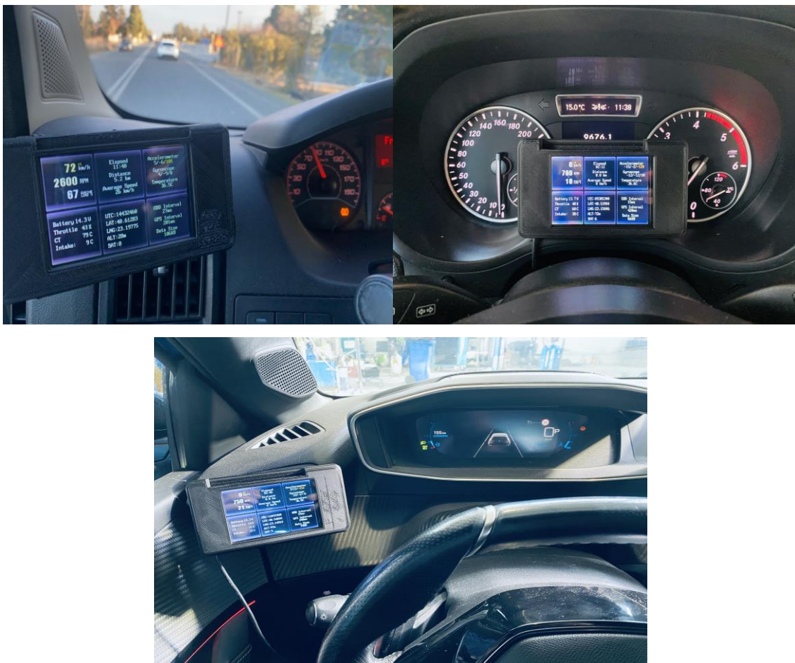
Εικόνα 33: Εφαρμογή κατασκευής πάνω στο όχημα με την χρήση μαγνητικής βάσης
