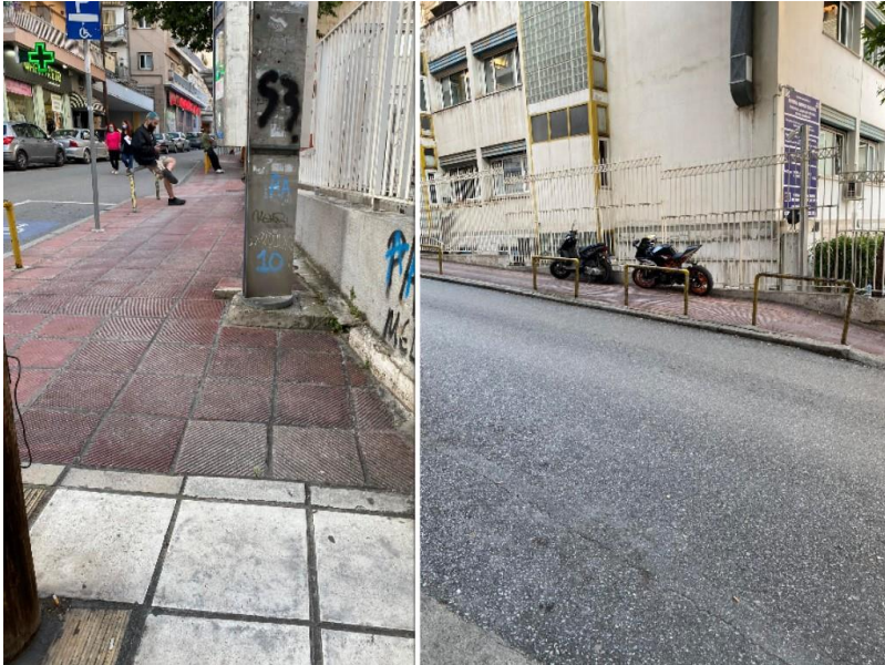
Εικόνα 20 : Απεικόνιση της έλλειψης οδηγών από τα πεζοδρόμια γύρω από το νοσοκομείο , επάνω στα οποία βρίσκεται η κεντρική είσοδός του
