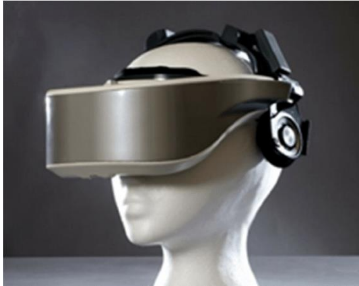
Εικόνα 12 Head Mounted Display (HMD) επιτρέπει την παρακολούθηση του κεφαλιού και τη στερεοσκοπική προβολή του 3D εικονικού περιβάλλοντος,
