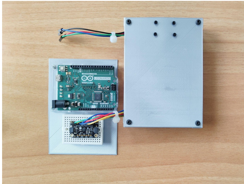
Εικόνα 29: Καλωδίωση των MPR121 και ADXL345 (βημα 3)
