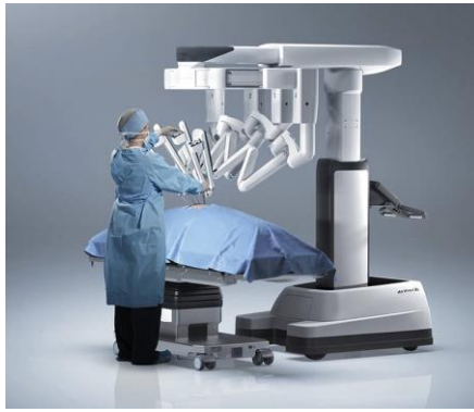
Σχήμα 23. Ρομποτικό χειρουργικό σύστημα Da Vinci (Πηγή: Τσακίριδης, 2021 )
