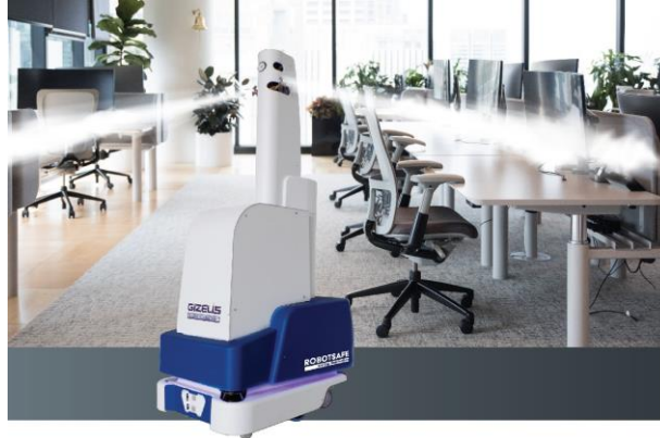
Σχήμα 24. Το απολυμαντικό ρομπότ RobotSafe™ της εταιρείας Gizelis Robotics (Πηγή: Euro2day, 2020 )
