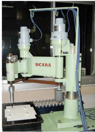
Σχήμα 13. Το ρομπότ SCARA, σχεδιασμένο από τον Hiroshi Makino (Πηγή: Gasparetto and Scalera, 2019:32)
