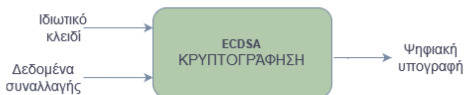
Εικόνα 18: Διαδικασία κρυπτογράφησης για την δημιουργία ψηφιακής υπογραφής
