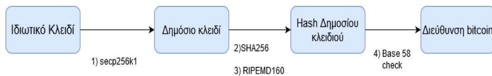
Εικόνα 16: Διαδικασία εύρεσης δημοσίου κλειδιού από ιδιωτικό κλειδί
