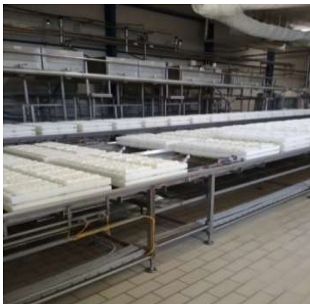
Εικόνα 5.8: Τυρόπηγμα σε καλούπια
