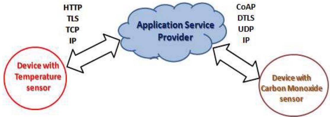
Εικόνα 7: Μοντέλο Διασύνδεσης Συσκευής με Πύλη (Nawazuddin Mohd1, 2018)
