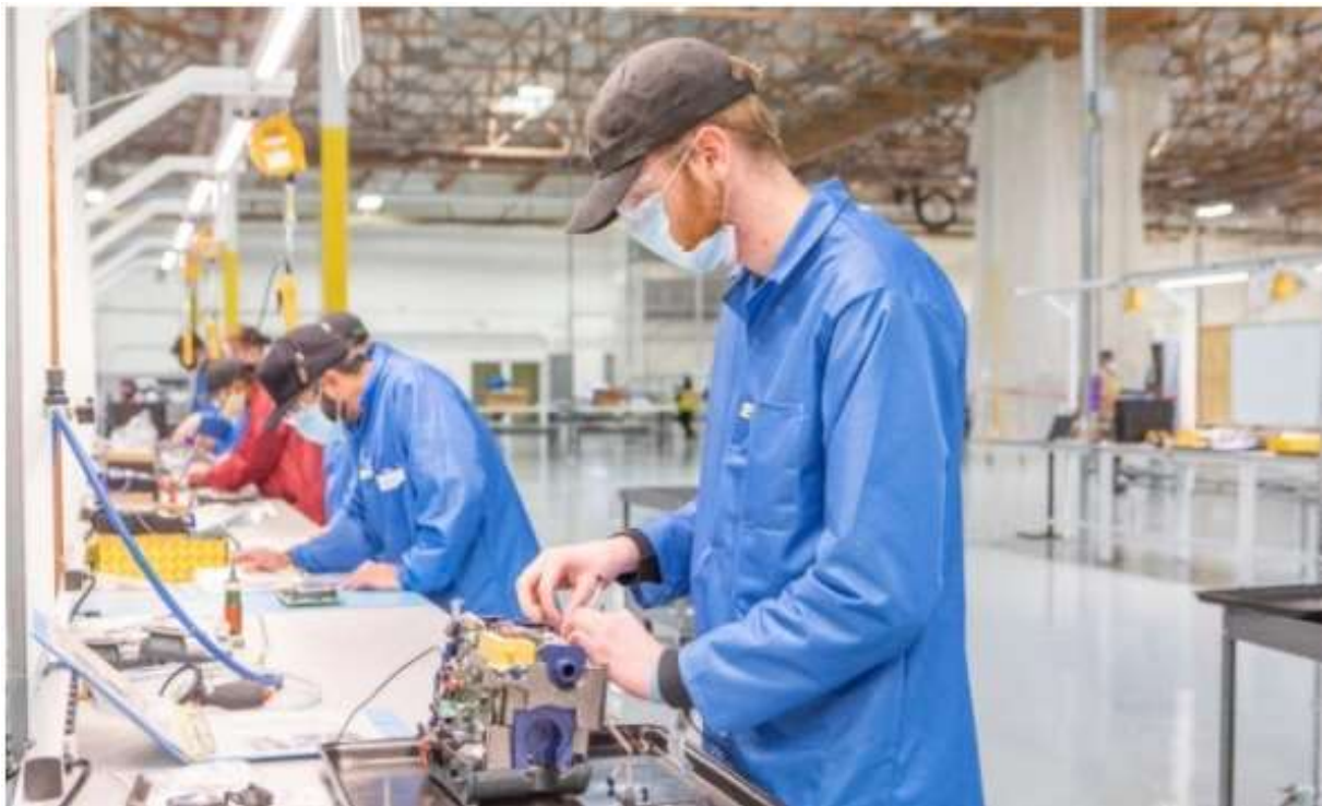
Εικόνα 1: Hamilton Medical Inc Συναρμολόγηση ενός ιατρικού αναπνευστήρα που αναπτύχθηκε με τη συμβολή μηχανικών της αυτοκινητοβιομηχανίας General Motors στη Νεβάδα. Πηγή: Freep.com
