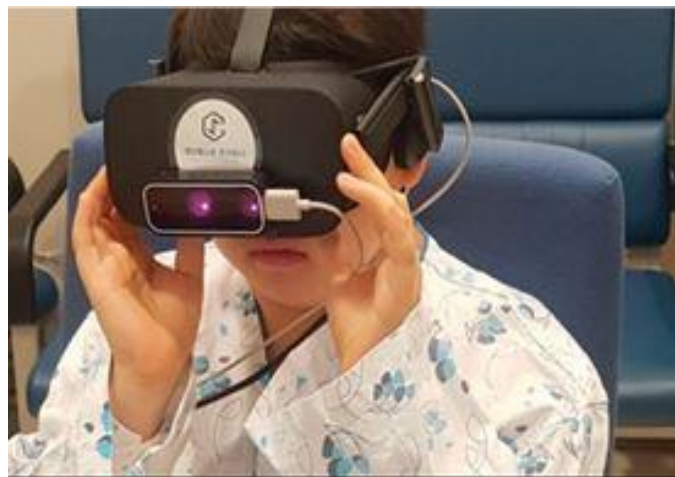
Εικόνα 3-6: VR μάσκα τοποθετημένη στο κεφάλι του παίκτη-ασθενή, με δυνατότητα κίνησης χεριών και δακτύλων (Ryu et al., 2018)
