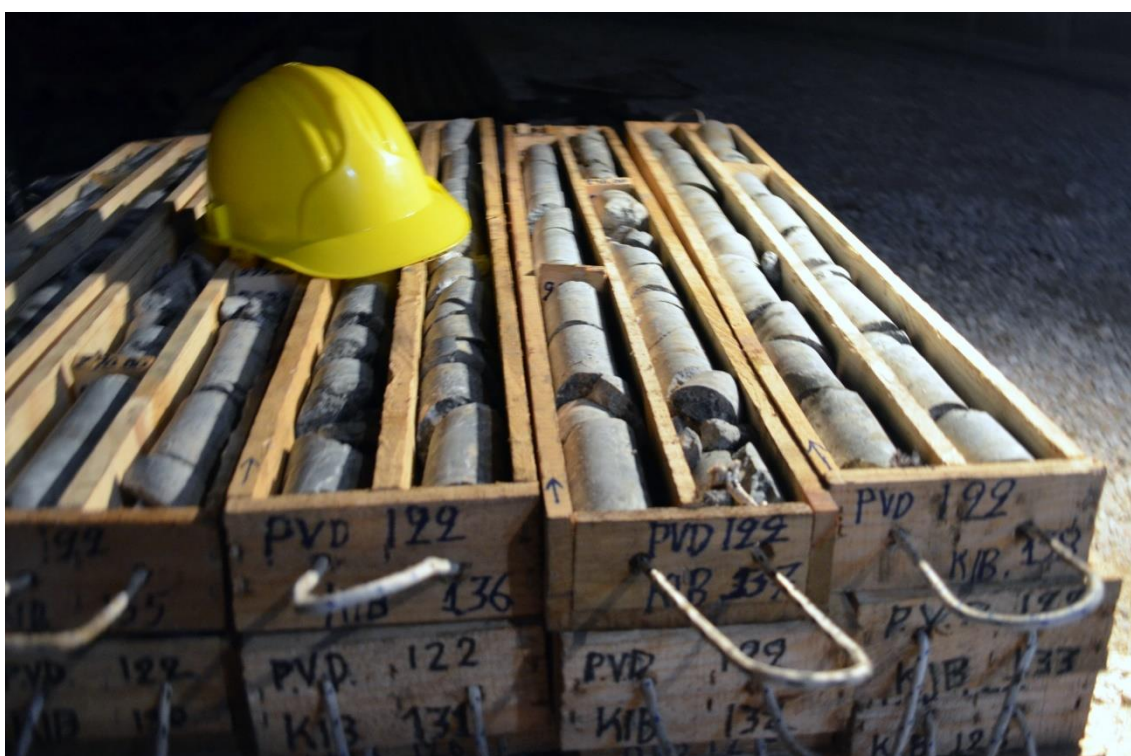
Εικόνα 1 : Δείγματα κυλινδρικής μορφής (καρότα)
