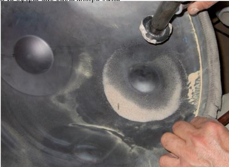
Εικ.2.25. Άμμος πάνω στην νότα κατά το κούρδισμα. Μια πολύ χρήσιμη και διαδεδομένη τεχνική.
