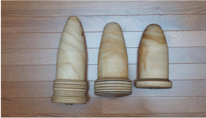
Εικ.2.17. Αυτοσχέδια εργαλεία από ξύλο για την διαμόρφωση του gu, τα οποία πιέζουν την τρύπα προς τα μέσα είτε με την χρήση πρέσας είτε χειροκίνητα με σφυρί.
