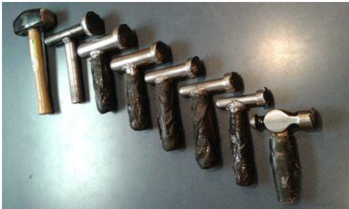
Εικ.2.19. Μικρά μεταλλικά σφυριά διαφορετικών σχημάτων, για διαφορετικές χρήσεις κατά το κούρδισμα.
