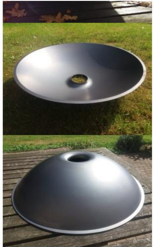
Εικ.2.3. Ημισφαίρια κατασκευασμένα από DC04.
