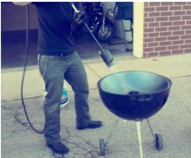
Εικ.2.27. Κάτω ημισφαίριο από handpan, το οποίο θερμαίνεται με πυρσό (heat gun).
