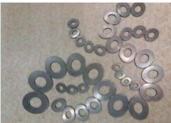
Εικ.2.15. Σειτ μεταλλικών δαχτυλιδιών που χρησιμοποιούνται για την διαμόρφωση των λακκουβών.
