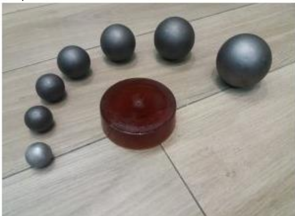
Εικ.2.13. Σειτ μεταλλικών σφαιρών που χρησιμοποιούνται για την διαμόρφωση των λακκουβών, και επιφάνεια από πολυουρεθάνιο για την προστασία του οργάνου.
