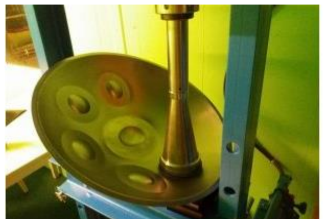
Εικ.2.16. Το μεταλλικό δαχτυλίδι πιέζεται με την χρήση πρέσας, δίνοντας το επιθυμητό σχήμα στις νότες (notefields)
