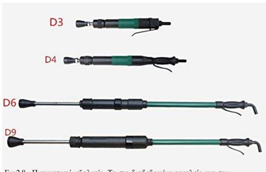
Εικ.2.8. Πνευματικοί εξολκείς. Το πιο διαδεδομένο εργαλείο για την διαδικασία της βύθισης.
