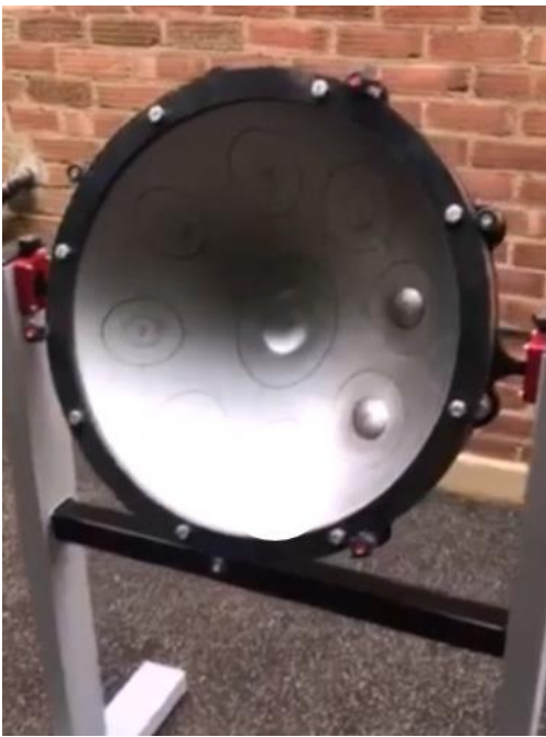
Εικ.2.23. Βάση για κούρδισμα. Μια καλή βάση μπορεί να περιστρέφεται, για να μπορεί ο κατασκευαστής να χτυπάει με τα σφυριά από όποια πλευρά θέλει.
