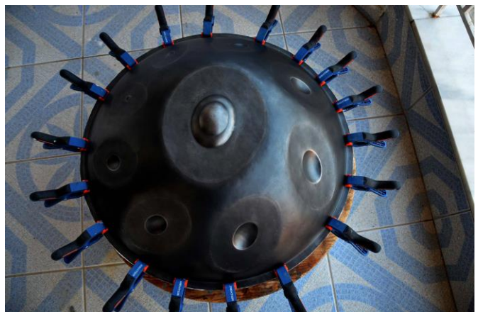
Εικ.2.28. Ταμανταλάκια τοποθετούνται περιμετρικά και κρατάνε σταθερά τα δύο ημισφαίρια μέχρι να στεγνώσει η κόλλα.
