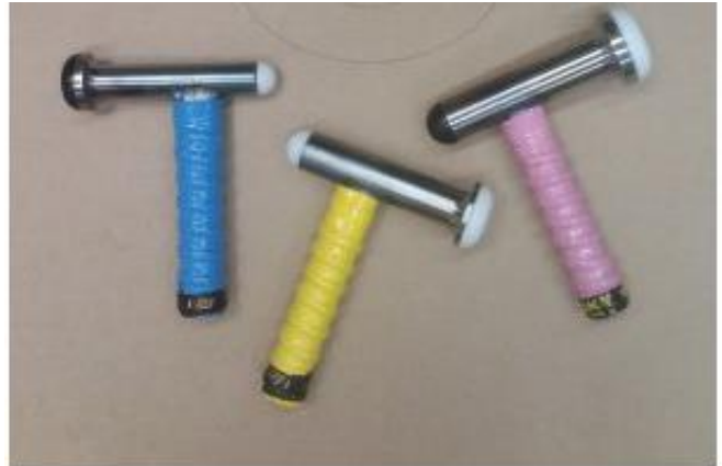
Εικ.2.20. Μικρά μεταλλικά σφυριά με δύο κεφαλές, οι οποίες έχουν πλαστικό στην άκρη, για να μην 'τραυματίζεται' το όργανο κατά το κούρδισμα..
