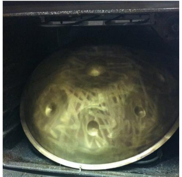
Εικ.2.26. Πάνω ημισφαίριο από handpan μέσα σε φούρνο.
