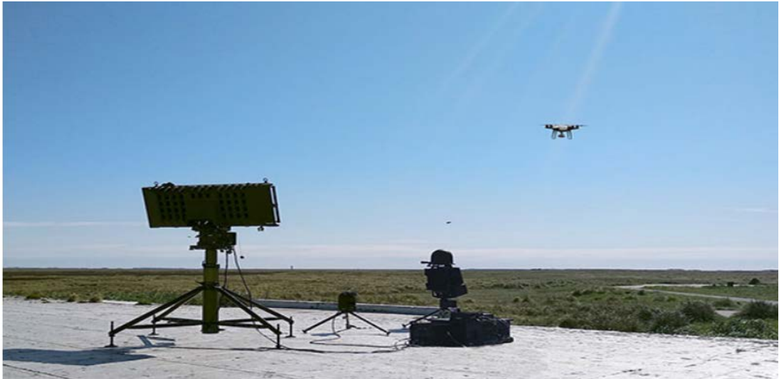
Εικ. 70 Σύστημα αντιμετώπισης LCC-UAS με RADAR, EO/TRACKER, ESM της εταιρίας IAI
