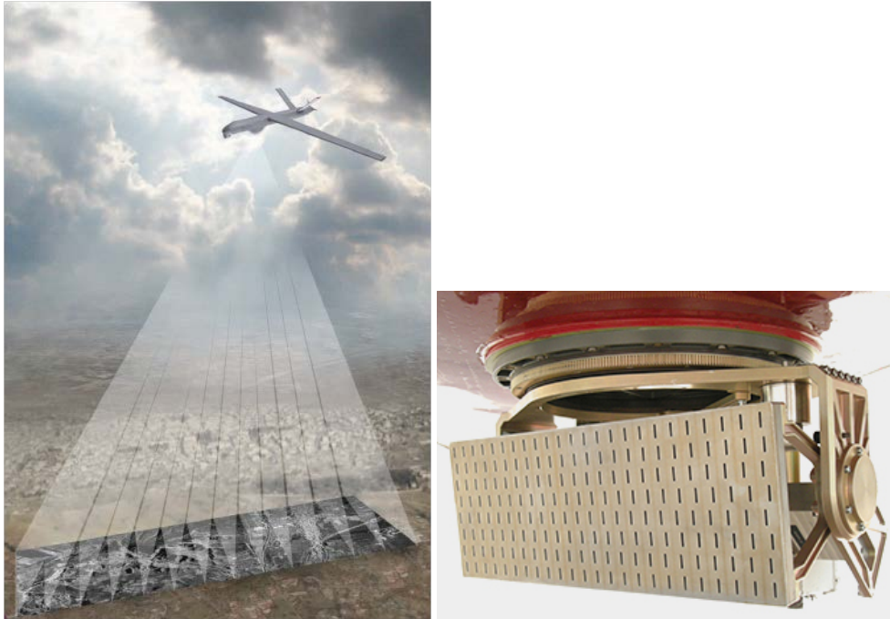
Εικ. 15 Radar SAR του UAS ANKA με δυνατότητα STRIP MODE
