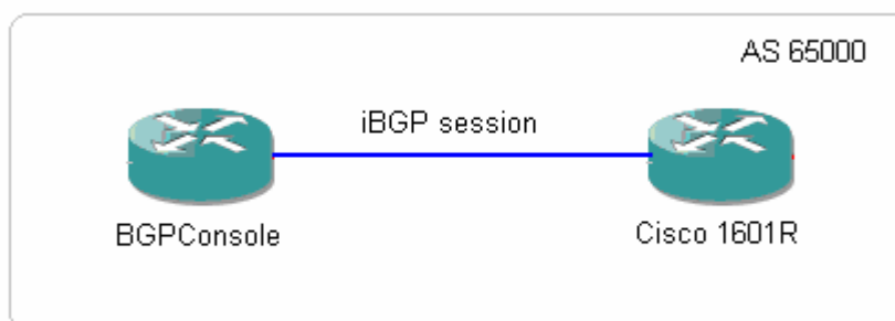
Εικόνα 7.3 : iBGP σύνδεση δύο δρομολογητών
