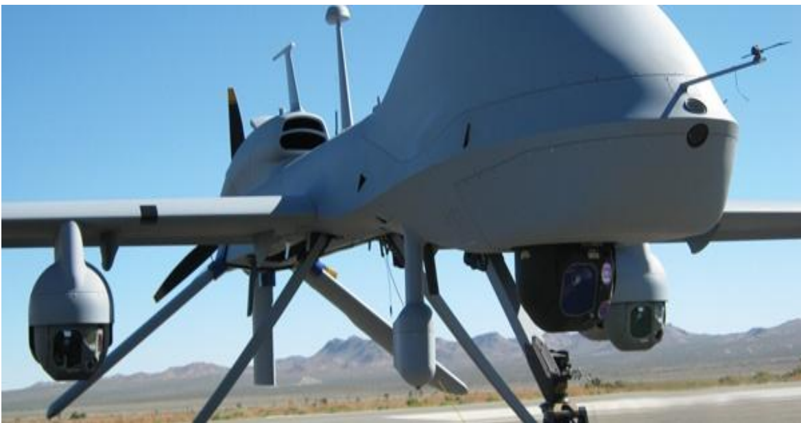
Υποσύστημα 4: Φορτίο Καμερών ΣμηΕΑ (DefencereDEFINED 2021)
