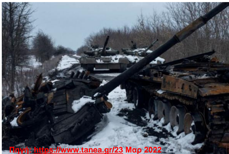
Εικ.14: Κατεστραμμένο ρωσικό άρμα με αποκολλημένο τον πύργο από το σκάφος
