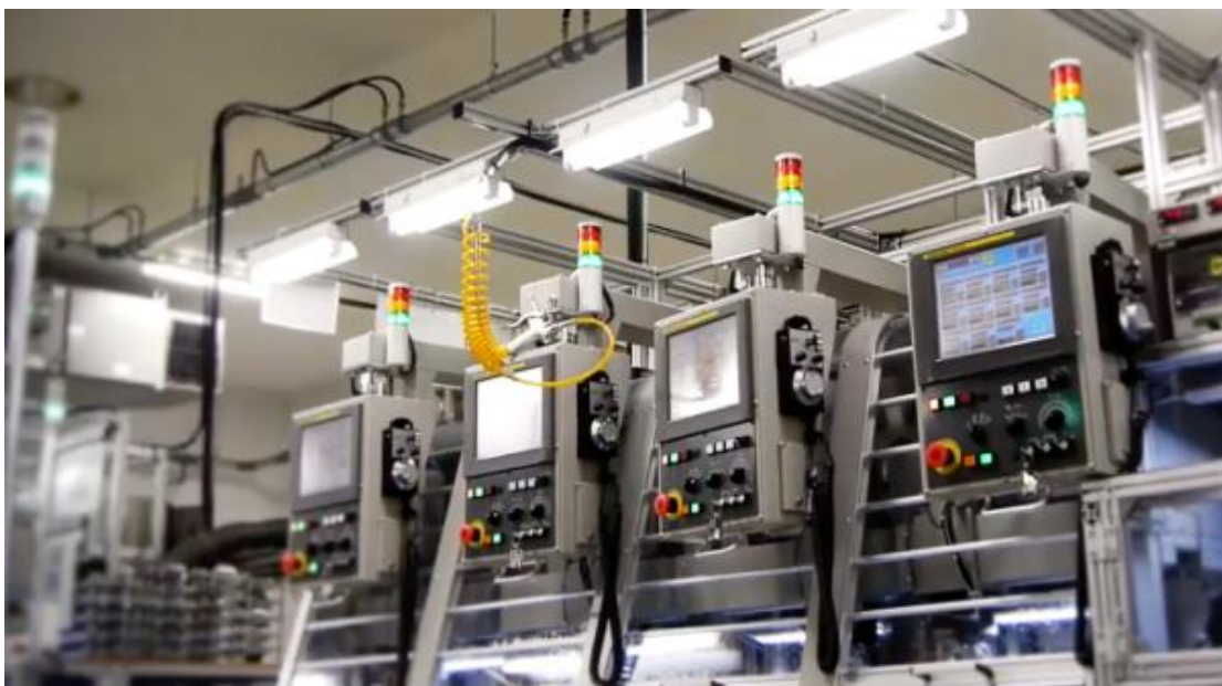
Εικόνα 15. Οπτικοακουστικό σήμα Kanban.
