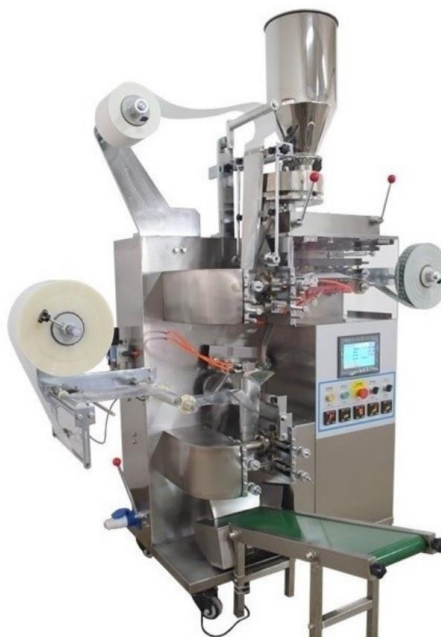
Εικόνα 17 : Μηχανή συσκευασίας για φάκελο ή πυραμίδα τσαγιού με προσαρμοσμένη ετικετέζα.
