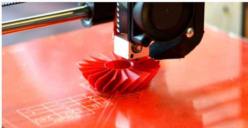
Εικόνα 9. Κατασκευή εξαρτήματος από πλαστικό με τη μέθοδο FDM.
