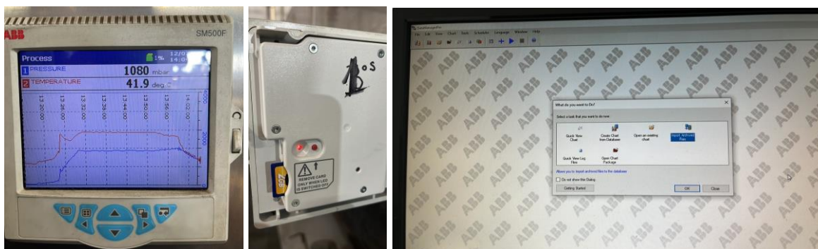
Εικόνα 23. Ψηφιακή συλλογή δεδομένων θερμικής επεξεργασίας και μεταφορά τους μέσω SD card προς αποθήκευση σε ειδικό λογισμικό
