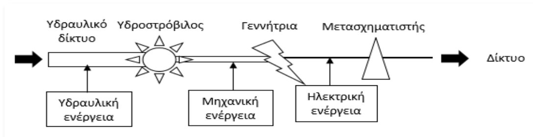
Εικόνα 6: Διαδικασία μετατροπής υδραυλικής ενέργειας σε ηλεκτρική ενέργεια
