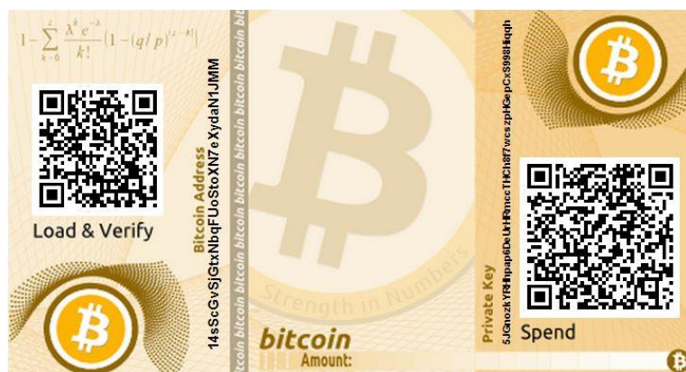
Εικόνα 4.2.9: Χάρτινο πορτοφόλι: Στα αριστερά της εικόνας εμφανίζεται η διεύθυνση μαζί με την αναπαράσταση του κωδικού QR. Στη δεξιά πλευρά εμφανίζεται το ιδιωτικό κλειδί, κωδικοποιημένο σε μορφή WIF, και ο σχετικός κωδικός QR.
