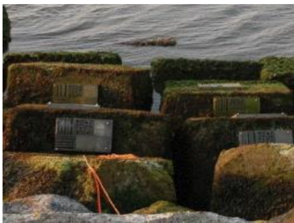
Εικόνα 37. Πλακέτες για την εγκατάσταση οργανισμών (publicwiki.deltares.nl, n.d.)
