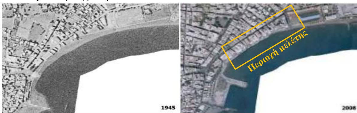
Εικόνα 29. Περιοχή μελέτης, εμφανής διάβρωση από το 1945 έως το 2008
