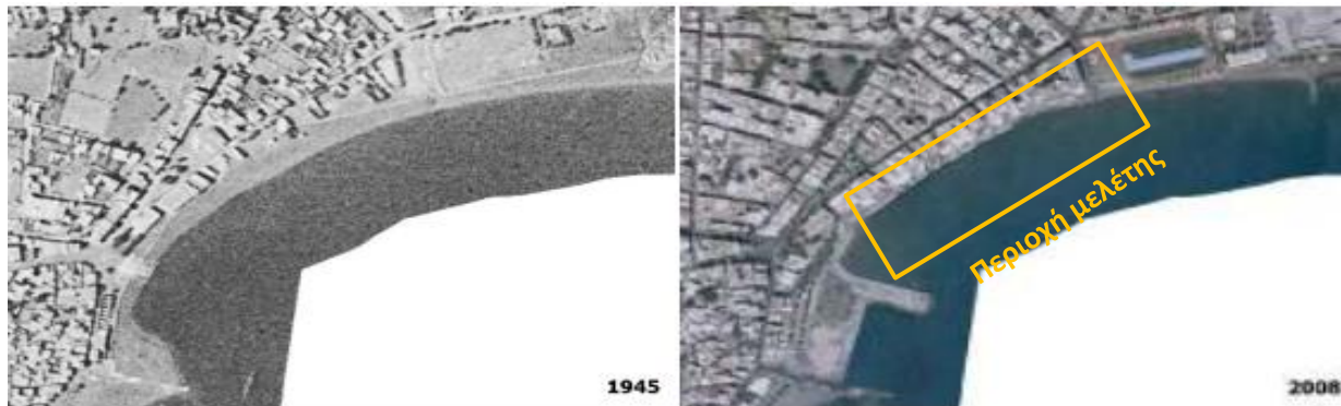
Εικόνα 1. Περιοχή μελέτης, εμφανής διάβρωση από το 1945 έως το 2008
