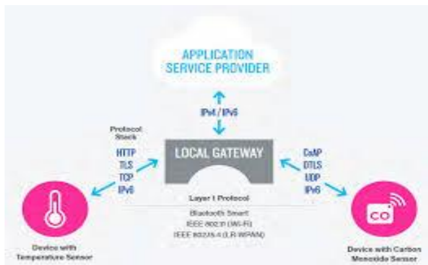
Εικόνα 8 Μοντέλο επικοινωνίας Device to Gateway.
