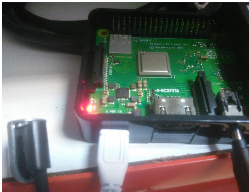
Εικόνα 3: Το Raspberry PI και ο αισθητήρας θερμοκρασίας που συνεχόμενα καταγράφει την θερμοκρασία του control room
