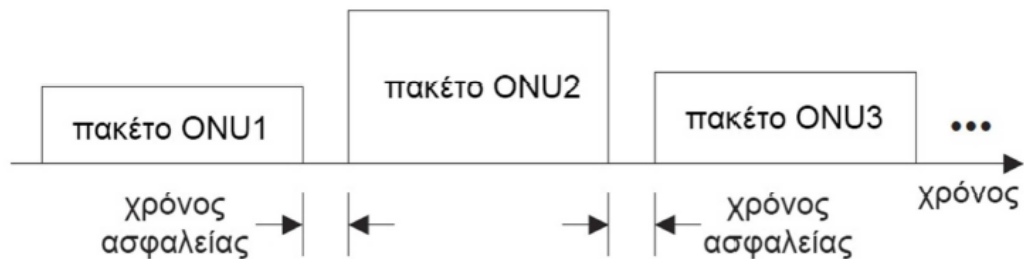
Εικόνα 9: Προσθήκη χρόνου ασφαλείας ανάμεσα σε ριπές (ITU-T Recommendation G.984.2, 2003).
