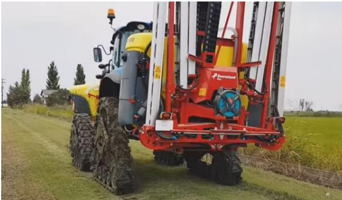
Εικόνα 45 Ιδιοκατασκευή για την εφαρμογή μεταβλητού ρυθμού ψεκασμού από κτήμα Κράββα
